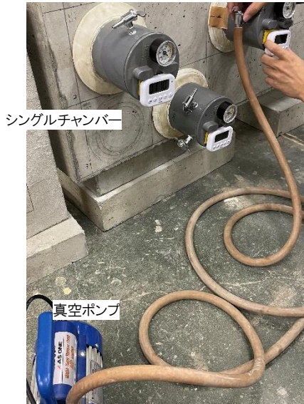
写真-2.1.3 簡易透気試験による測定状況
