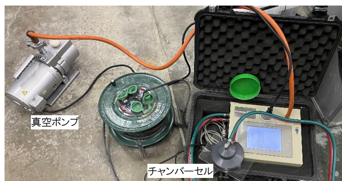
写真-2.1.1 透気試験機（ダブルチャンバー法）
