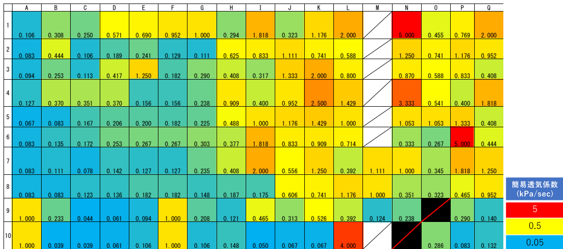
図-4.1.4 樋門側壁（簡易透気係数、2022年3月測定）
